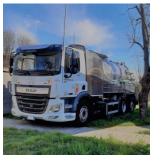
Autospurgo Daf CF450 FAN targato GA242CH: autocarro a 3 assi, con portata utile di kg. 12.000 per una massa di ton. 26.
