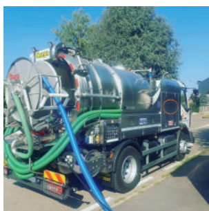
Autospurgo Renault D13 targato GR750BM: autocarro a 2 assi, con portata utile di kg. 7.200, munito di cisterna aspirante.
