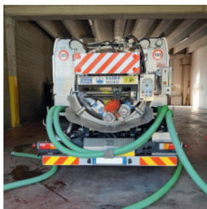
Autospurgo Isuzu F11 targato GW113KJ: autocarro a 2 assi, con portata utile di kg. 3.600 per una massa di ton. 7,49. Munito di cisterna aspirante in acciaio INOX.
