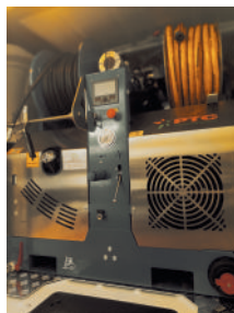
Furgone Citroen Jumpy targato GK779NZ con attrezzatura Mecom PTC Salmon per disotturazioni: motore a benzina, pompa volumetrica, naspo ad alta pressione, radiocomando.
