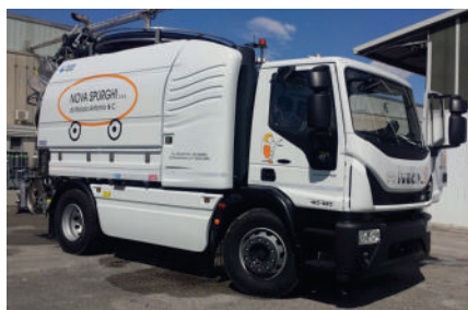
Autospurgo Iveco 180 targato FJ024DA: autocarro a 2 assi, con attrezzatura SV7 con cisterna ribaltabile in acciaio al carbonio dalla capacità di lt. 7.280.
