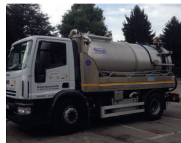
Autospurgo Iveco 180 targato EL243DF: autocarro a 2 assi, con portata utile di kg. 7.480 per una massa di ton. 26.
